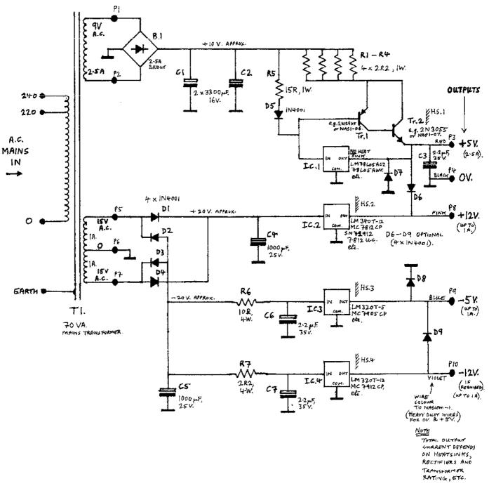
THE ABOVE CIRCUIT IS INTENDED TO SUMPLY THE MAIN NASCOM: I CALL BOARD PLUS AT LEAST ONE COMPLETE MEMORY EXPANSION BOARD.
